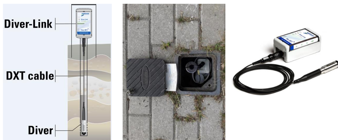
Figuur 6 Peilbuis met telemetrische datalogger in straatpot
